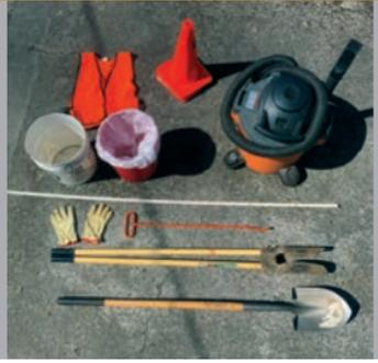
**Шаг 1.** Снимите крышку люка с помощью специального инструмента. **ВНИМАНИЕ!** Крышка тяжелая — применяйте соответствующие технические приемы.
